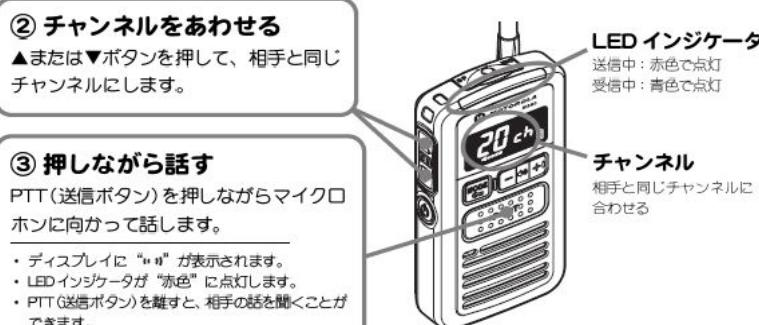
◎ 相手の声を聞きながら、音量調節ボタンで音量を調節してください。
