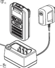
② ACアダプタをコンセントに差し込み、電源を切ったトランシーバーをチャージヤースタンドに挿し込みます。
